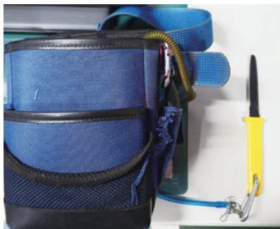
倉庫内で使用する道具入れ。安全性の高い段ボールカッターをセーフティーコードにつなげている。
